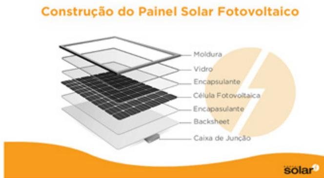
**Figura 1.** Painel Solar Fotovoltaico
