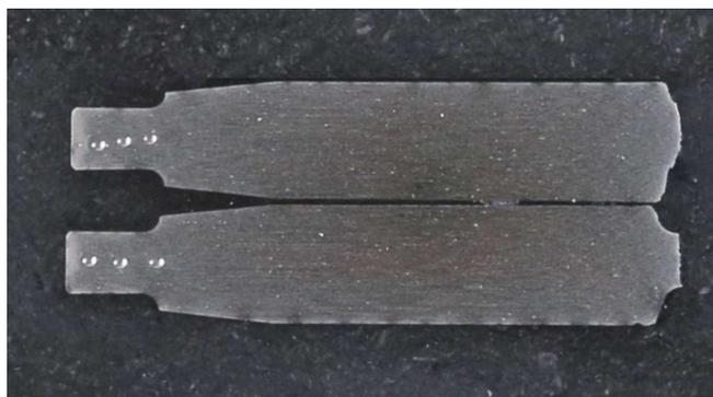
Figura 7: Imagem representativa do ensaio de dureza.
