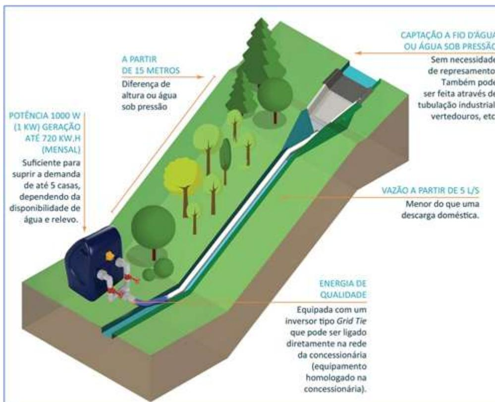
Figura 2 - Esquema de funcionamento.
