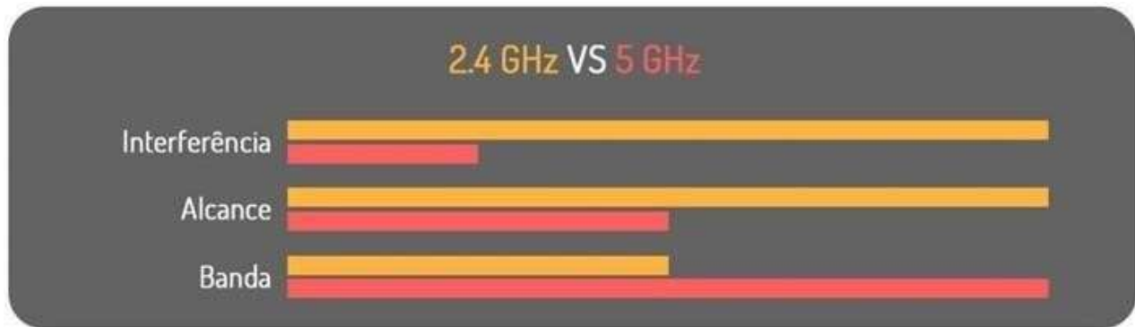
Figura 4 - Diferença entre Redes Wi-fi Fonte: EXAME, 2018.
