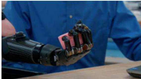
Figura 7 – Operação do membro protético modular por um amputado
